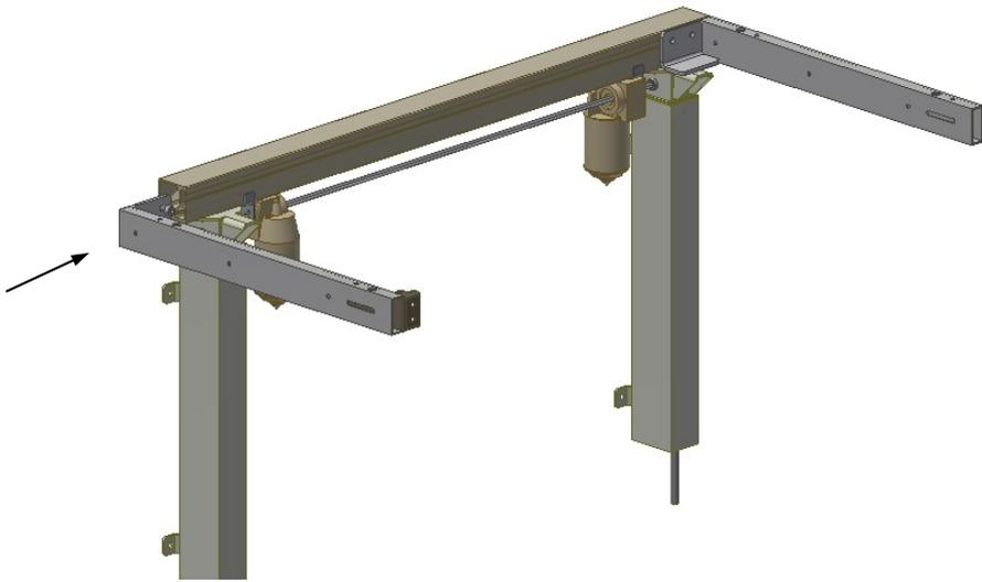
8.6.1 Die Auflagekonsole in das Aluminiumprofil schieben, sodass die Auflagekonsole waggerecht mit dem Aluminiumprofil ist. Danach die Schrauben anziehen. Bei Anwendung von dieser Montagekonsole, ist es möglich Kochplatte oder Spülbecken dichter an der Tischplattenkante zu montieren.
