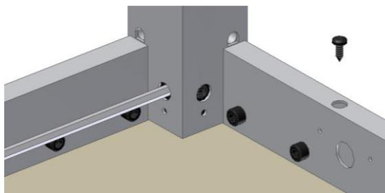
6.1.5 Die Tischplatte durch die Löcher der Zargen mit Schrauben befestigen.
