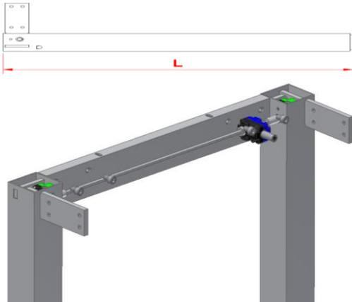
6.1.1 Überprüfen, ob die Höhe (L) der 4 Beine gleich ist. Kann an Sechskantwelle mit dem Gabelschlüssel justiert werden. Seitenzargen auf eine ebenen Oberfläche legen und Beine montieren. s. Beinetikett
