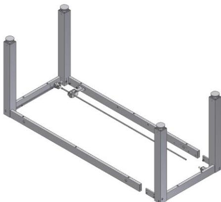
6.1.3 Jetzt die beiden Vorderzargen montieren. Schrauben mit dem mitgelieferten Schlüssel fest anziehen.
