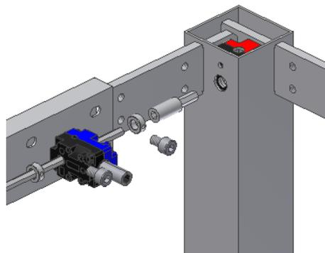
6.1.2 Die Umlenkgetriebe müssen auf der Welle fixiert werden, dazu die Anschlagring auf beiden Seiten des Getriebes montieren. Die Ringe erst nach Zusammenbau anziehen.
