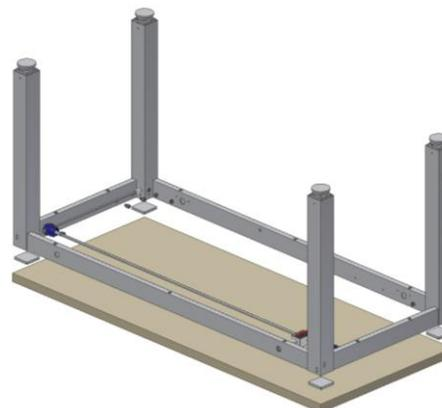
6.1.4 Rahmen auf Tischplatte anbringen und Deckplatten zwischen Beine und Tischplatte schieben. Rahmen auf Tischplatte zentrieren
