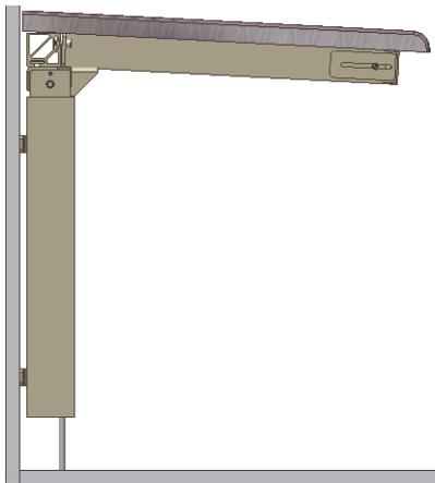
6.6.1 Nach Belastung des Rahmens mit der Auflageplatte kann ein Ausrichten notwendig sein, falls der Rahmen von der Wand bis zur Vorderzarge nicht länger waagrecht ist.
