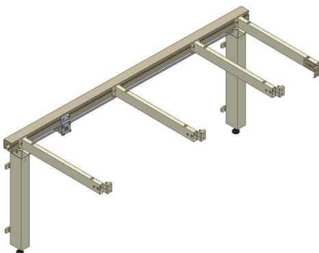
6.3.1 Den Flexi an die Wand anbringen und nach dem Lot ausrichten. Die beiden Stellschrauben unter den Montagekonsolen so einstellen, dass der Rahmen waagrecht ist.
